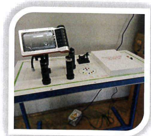
Stacja bazowa systemu nawigacji z symulatorem opryskiwacza, rozsiewacza i siewnika
